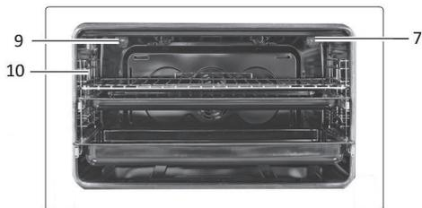
Die seitliche Backraumleuchte (10) ist mit einer gesteckten Glasabdeckung versehen. Zum Leuchtmitteltausch muss die Glasabdeckung abgenommen werden.
